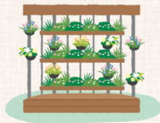
カーテン型 壁状に緑化することで、朝夕の日射、特に強い西日などを遮ります。
