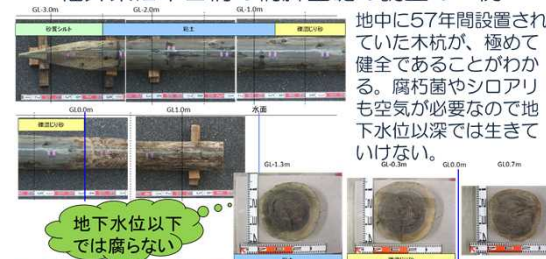
図 丸太は地下水位以下では腐らない
