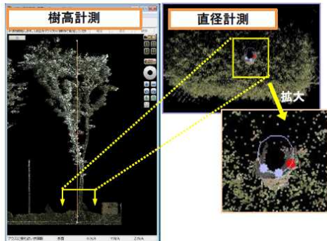
図 3次元点群データによる街路樹の樹高・直径の計測イメージ
