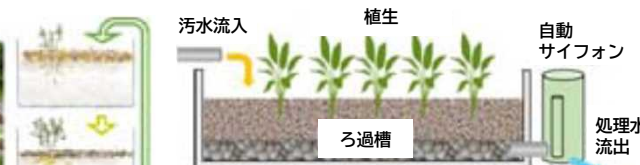
図 タイダル式水質浄化システム
