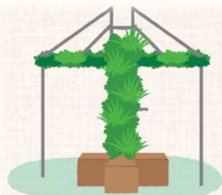
パラソル型 上部を緑化することで、太陽高度の高い日中の日射を効果的に遮ります。
